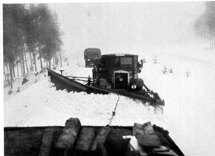
Abb. 7. Schweres Schneeräumgerät bei der Arbeit mit Vorspann
